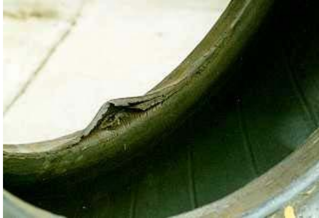
Figura 7. Daños en el Aro
